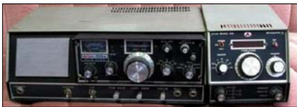
Sl. 62a. Nova konzola za smeštaj transivera Atlas 210/215X sa spoljašnjim VFO, koji ima digitalnu skalu
