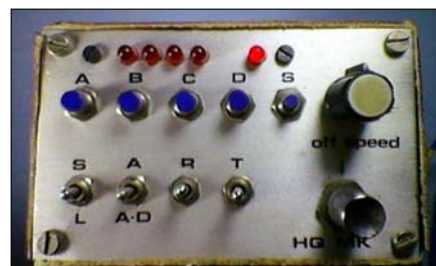
Sl. 70. Prednja ploča elektronskog tastera od YU1EU, sa memorijom, koji je YU1NVI koristio pri MS radu
